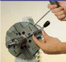
Sistema di il serraggio rapido delle placchette QTC® (Quick-Tool-Change).
