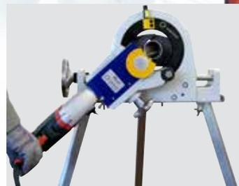
Per il taglio di tubi e curve di piccolo spessore
