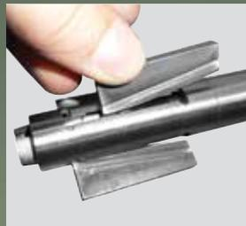
Il sistema di espansione "NC" garantisce una maggiore stabilità della macchina durante la lavorazione.
