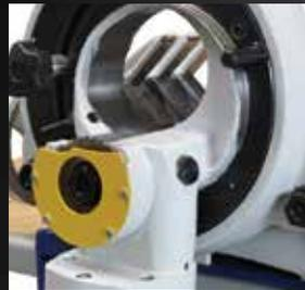
Posizione lama esterna per il taglio delle curve
